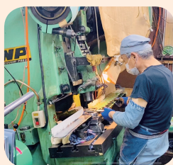
②板を丸く切り抜く作業
